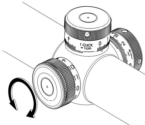
Abb. 5: Bedienung der Beleuchtung
