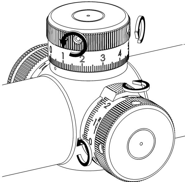
Abb. 8: Nullen des Zielfernrohrs – Lösen der Schrauben
