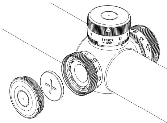
Abb. 6: Batteriewechsel
