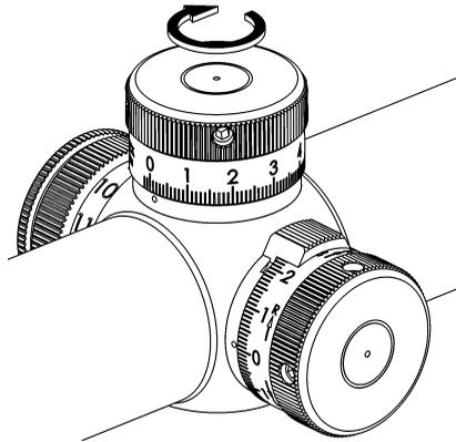
Abb. 9: Korrektur eines Tiefschusses
